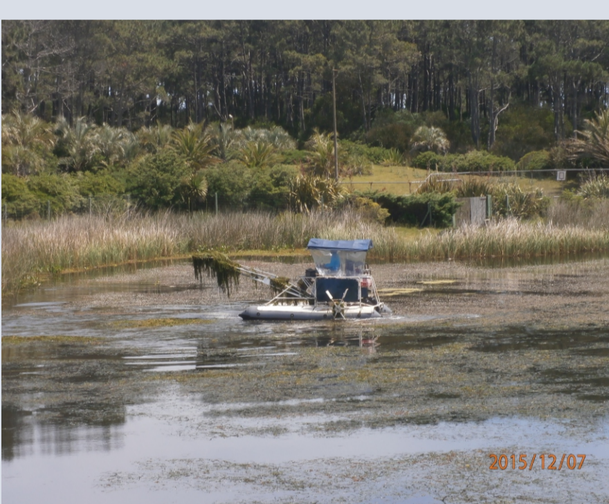
Corte de la vegetación macrófita sumergida y emergente en la Laguna del Diario. Se observa la máquina que realiza el corte y sitios de acopio de la vegetación cortada.
