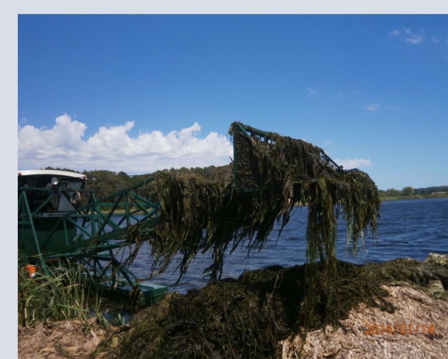
Corte de la vegetación macrófita sumergida y emergente en la Laguna del Diario. Se observa la máquina que realiza el corte y sitios de acopio de la vegetación cortada.
